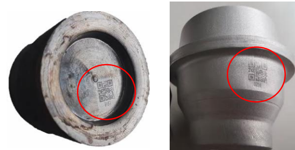
Eindeutig identifizierbare Bauteile trotz Erwärmung, Umformung und Oberflächenbearbeitung
