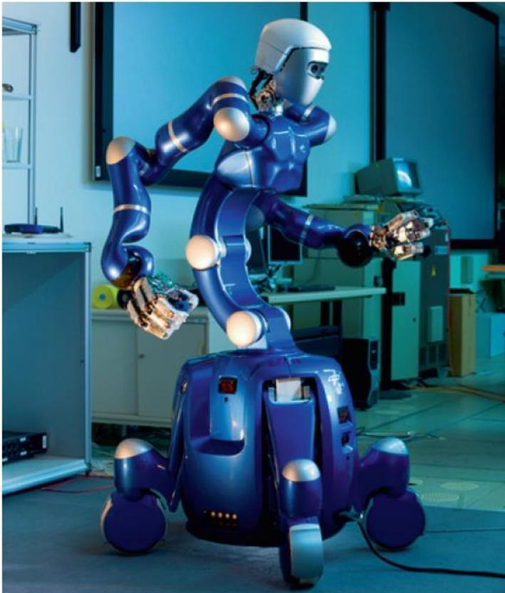
Bild 3. Justin ist Prototyp für einen zweihändigen humanoiden Roboter mit 51 Freiheitsgraden. Zudem versteht er natürliche Sprache. (Quelle: Thomas Ernsting)
