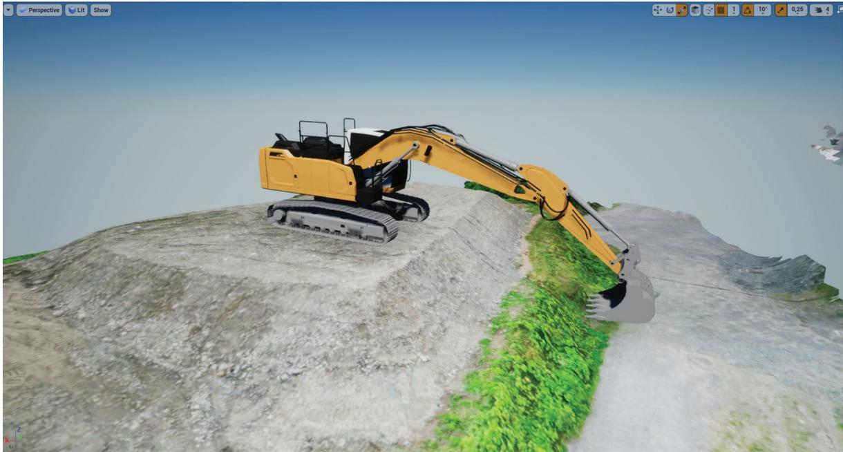
Simulation eines konkreten Szenarios zur Absicherung der zuverlässigen Erkennung von Abhängen
