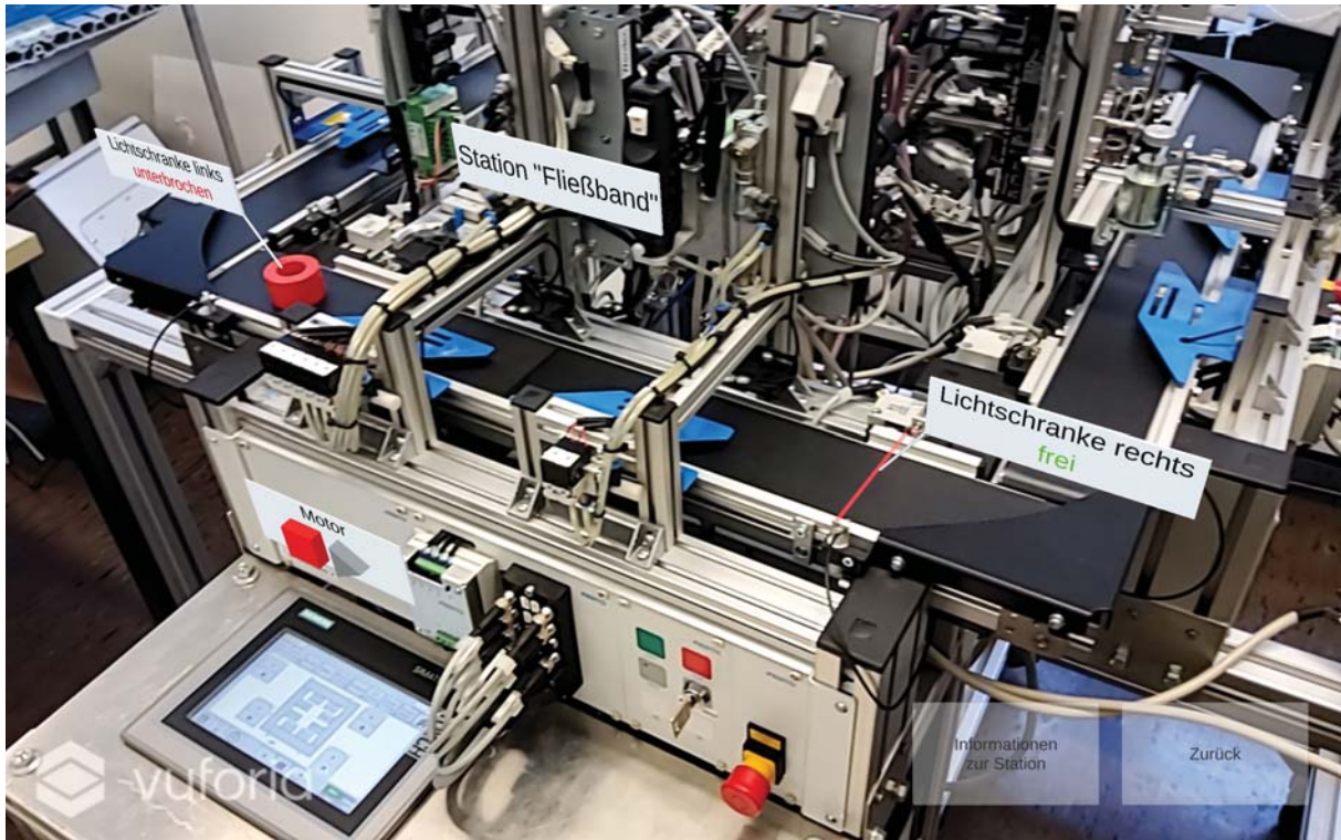
Digitaler Zwilling eines Modulare Produktionssystem mit Anzeige der Informationen im Kamerabild des Tablets
