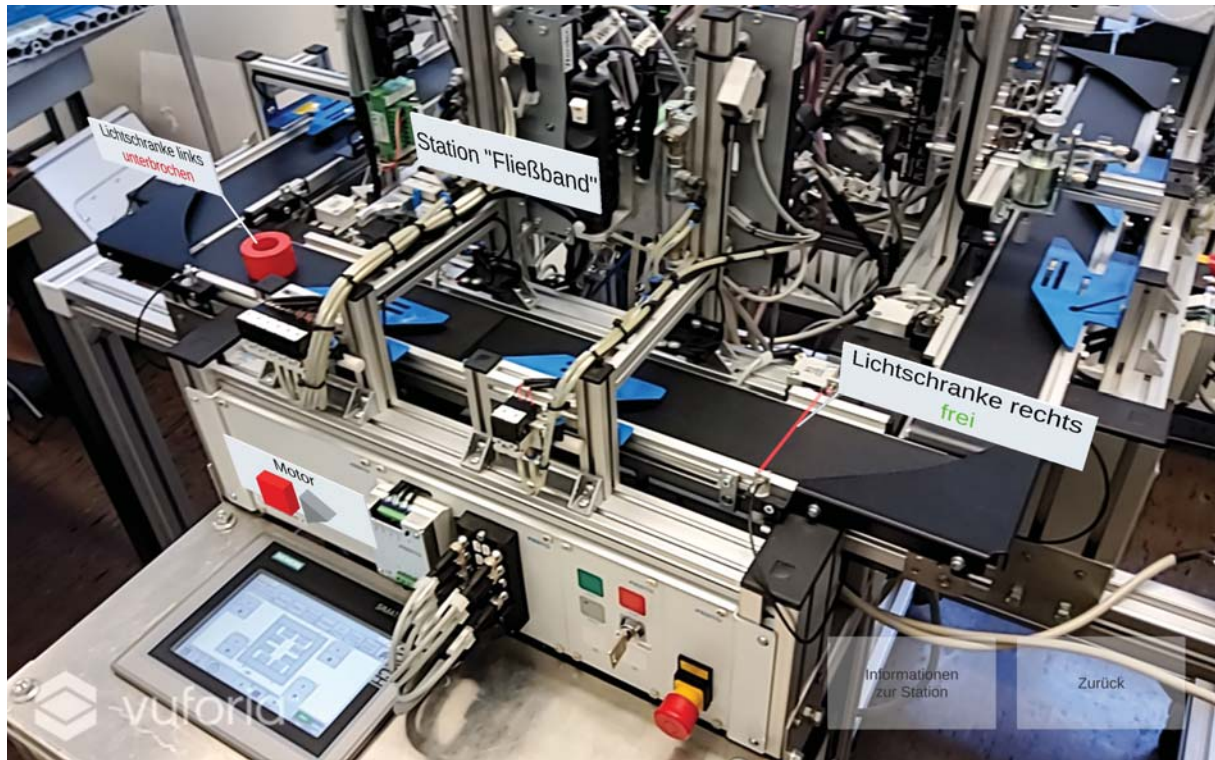
Digitaler Zwilling eines Modulare Produktionssystems mit Anzeige der Informationen im Kamerabild des Tablets
