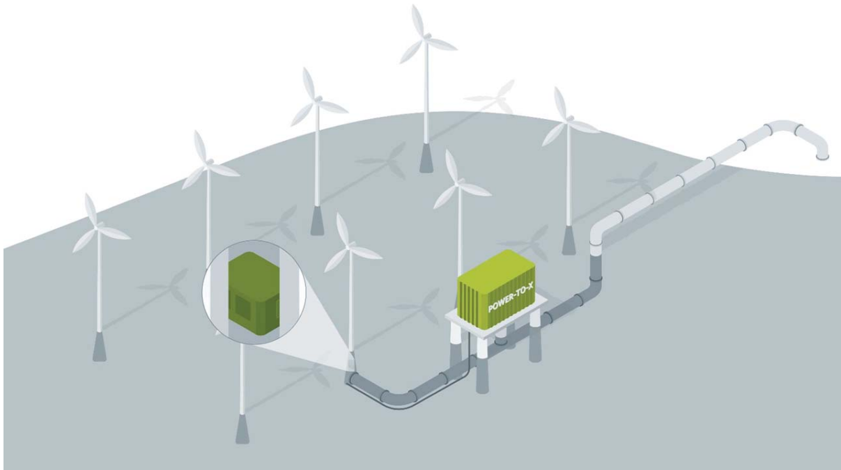
H 2 Mare - Wasserstoff und synthetische Kraftstoffe direkt auf dem Meer produzieren Grafik: Projektträger Jülich im Auftrag des BMBF
