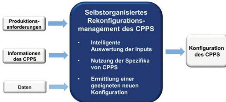
Selbstorganisiertes Rekonfigurationsmanagement Cyber-Physischer Produktionssysteme (CPPS)
