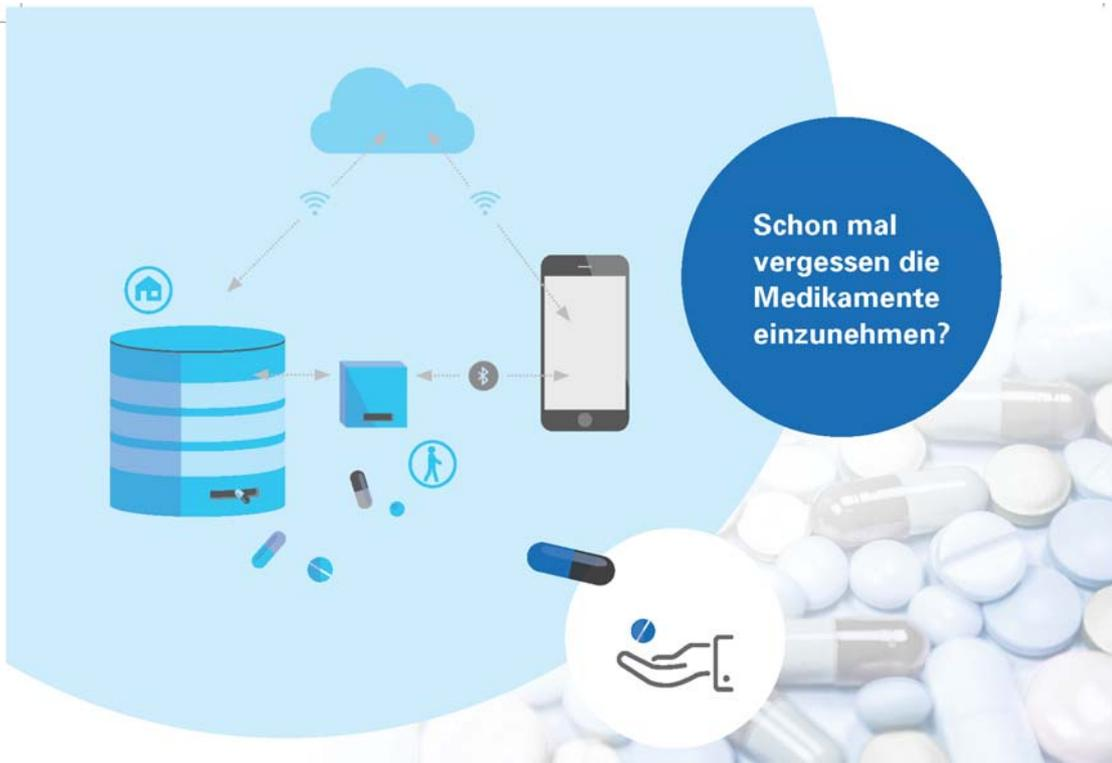
Schematische Darstellung der Vernetzung des stationären und mobilen Tablettendispensers mit dem zentralen cloudbasierten Server
