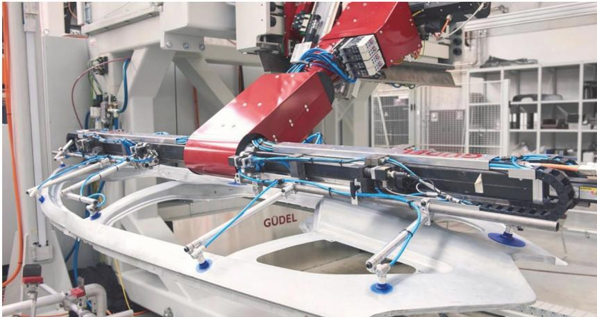
Abbildung 62: Beispielhaftes Vakuum-Greifsystem im Automobil-Karosserierohbau (Bildquelle: [98])
