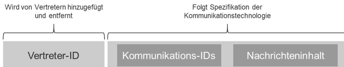
Abbildung 16: Kommunikationsnachrichtenspezifikation
