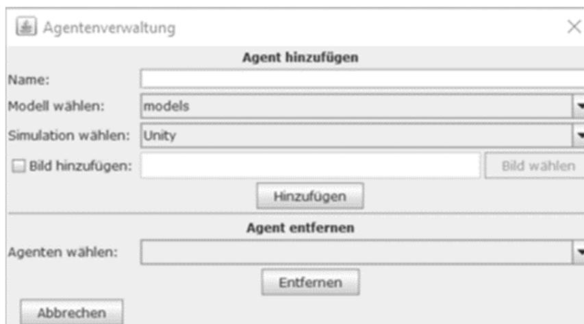
Abbildung 37: Benutzeroberfläche zum Einbinden einer Teilsimulation
