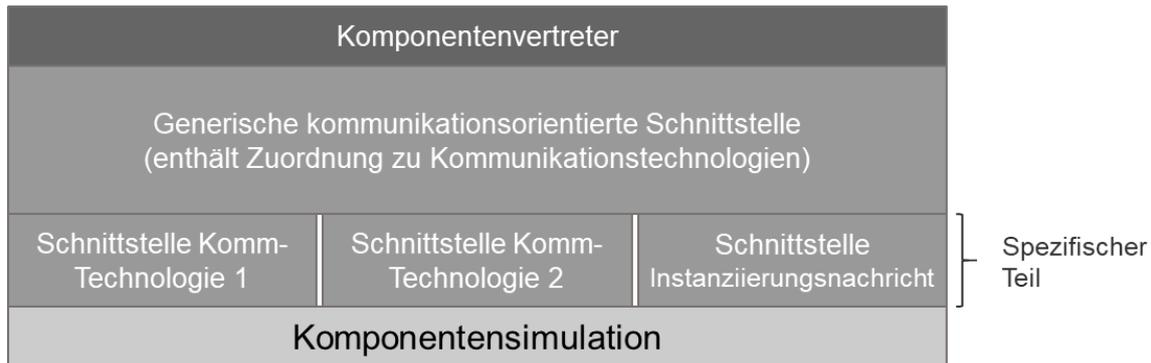
Abbildung 18: Kommunikationsorientierte Schnittstelle einer Komponentensimulation
