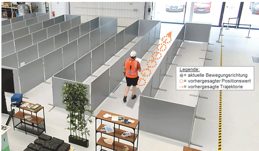
Abbildung 28: Lineare Bewegung, Anwendung Constant-Velocity-Trajektorienvorhersage
