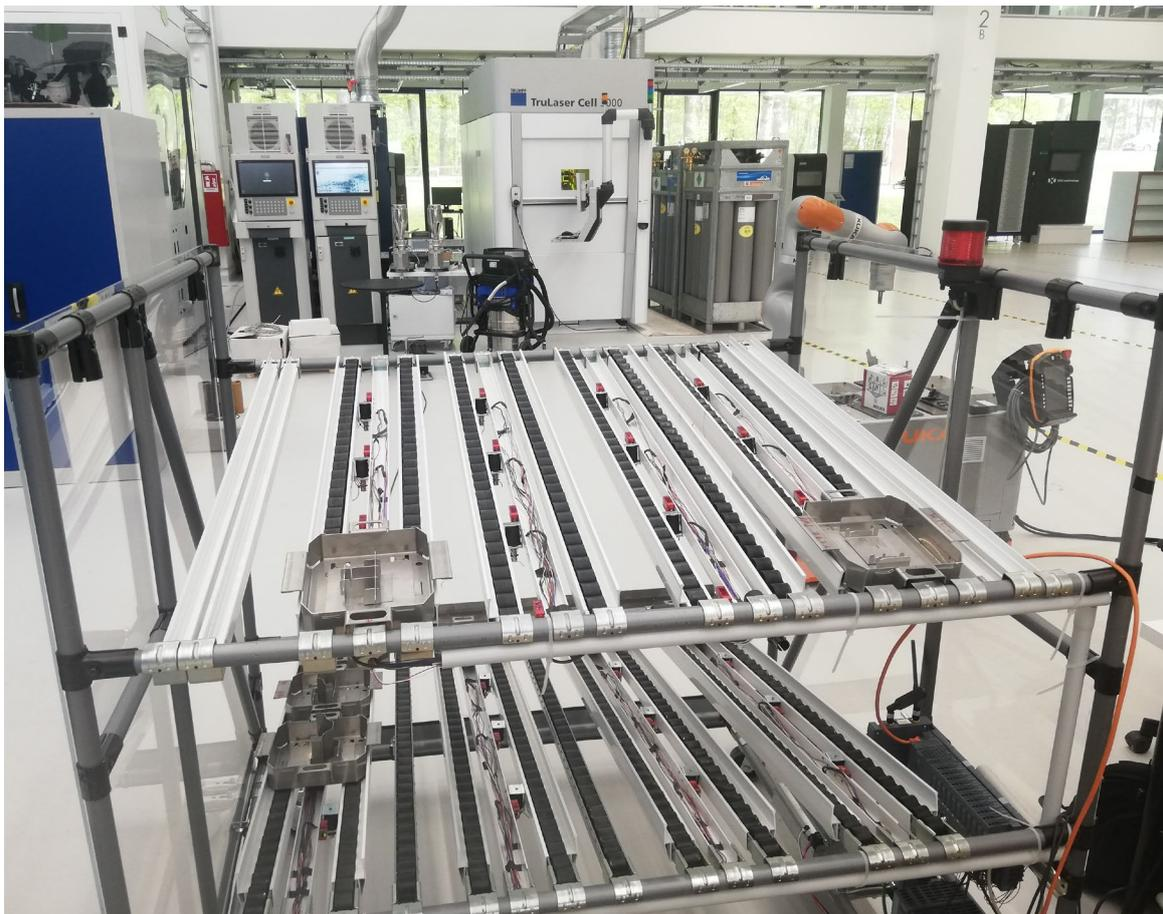
Abbildung 6.2: Blick auf das intelligente Lager mit dem teilweise verdeckten mobilen Roboter, der Laserbearbeitungsmaschine und der übergeordneten Steuerung im Hintergrund
