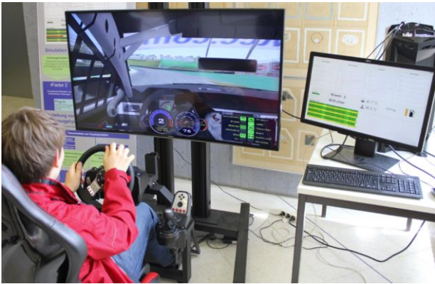
Abbildung 1 Beispielhafter Hardwareaufbau zur Steuerung des LKWs und Visualisierung der Fahrzeugumgebung – Kamera zur Fahrerüberwachung ausgenommen [21]
