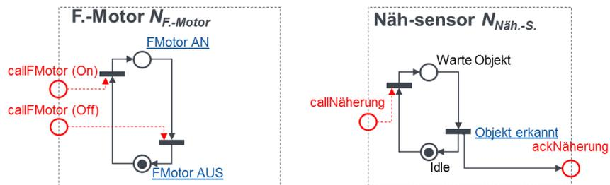
Abbildung 5: Schnittstelle zum technischen Prozess (links), Schnittstelle vom technischen Prozess (rechts)
