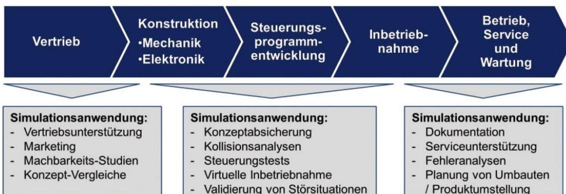
**Bild 1. Anwendung maschinennaher Simulation im Entwicklungs- und Herstellungsprozess von Produktionssystemen**
