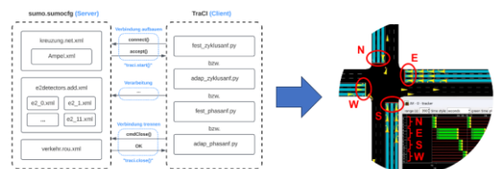
Entworfene Systemarchitektur und resultierender Prototyp der intelligenten Ampelkreuzungs-Steuerung
